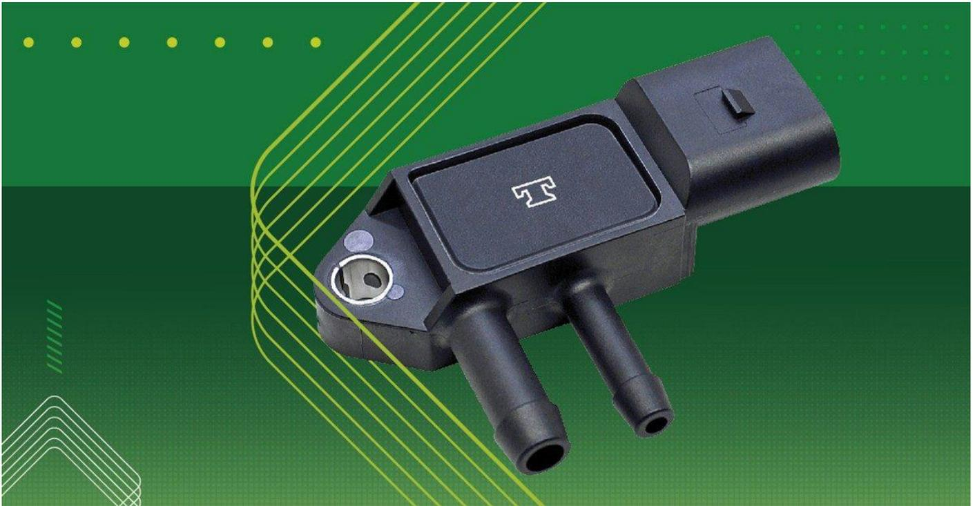
O sensor EGPS mede a pressão dos gases do escape antes e depois do filtro de partículas. Ao monitorizar as diferenças de pressão entre estes dois pontos, determina-se o nível de saturação do filtro. Esta informação permite que o sistema de controle das emissões efetue a regeneração, de acordo com as normas de emissão.
