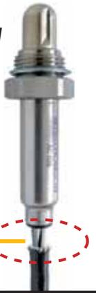
**C.** Faça o teste da resistência do aquecedor.
