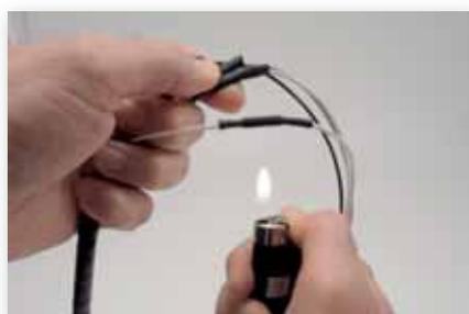
Com o isqueiro aqueça o termoencolhível até que retraia e envolva toda a conexão
